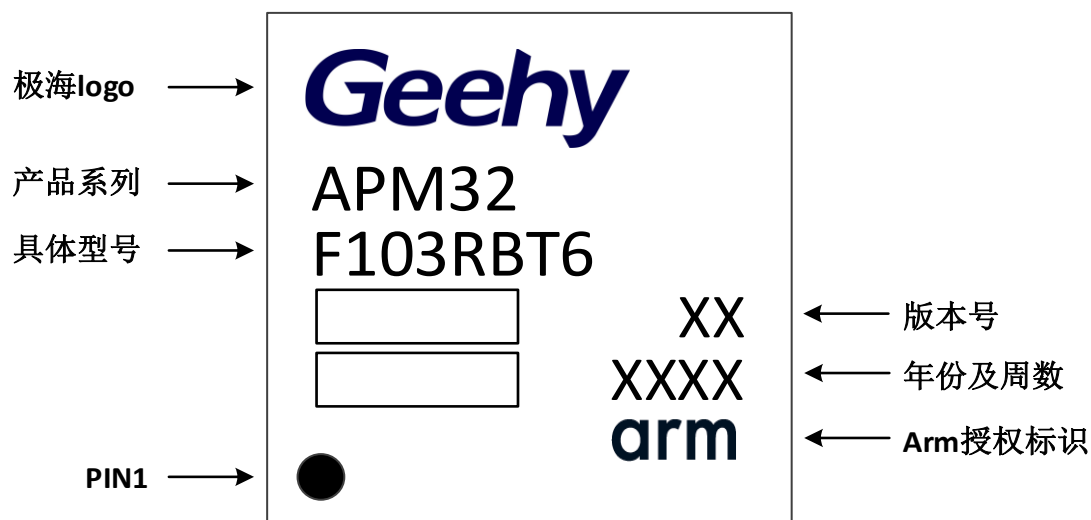
图26 LQFP64 - 64 引脚，10 x 10mm 封装标识
