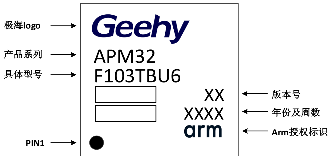
图32 QFN36 - 36 引脚，6 x 6 mm 标识图
