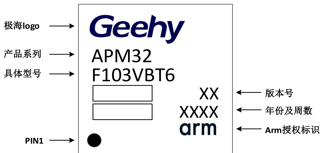
图23 LQFP100 - 100 引脚，14 x 14mm 封装标识
