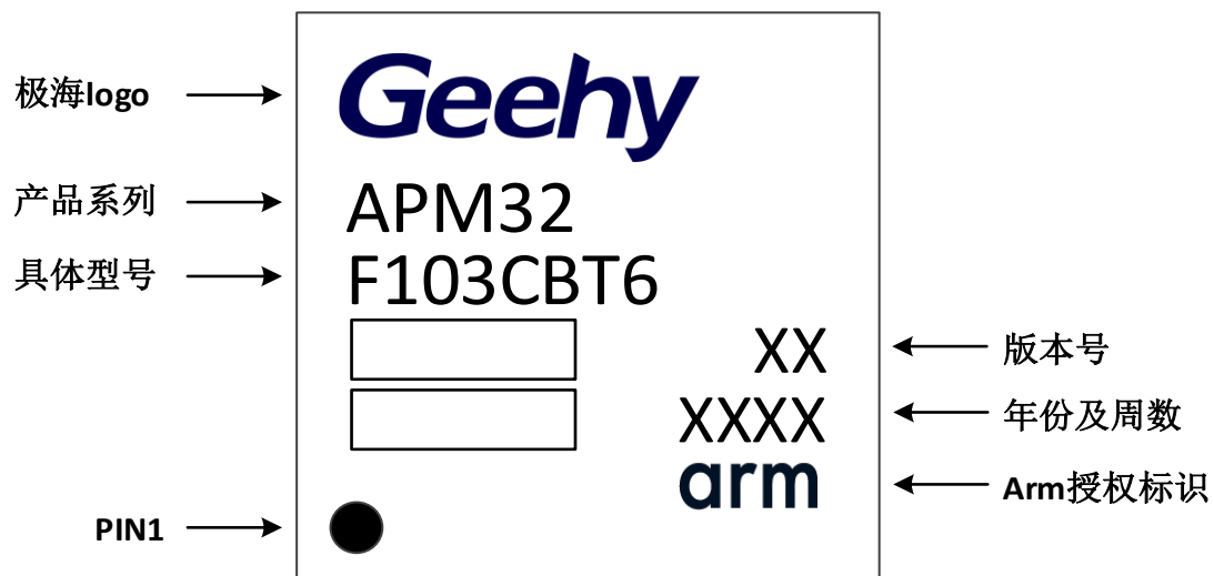
图29 LQFP48 - 48 引脚, 7 x 7 mm 标识图
